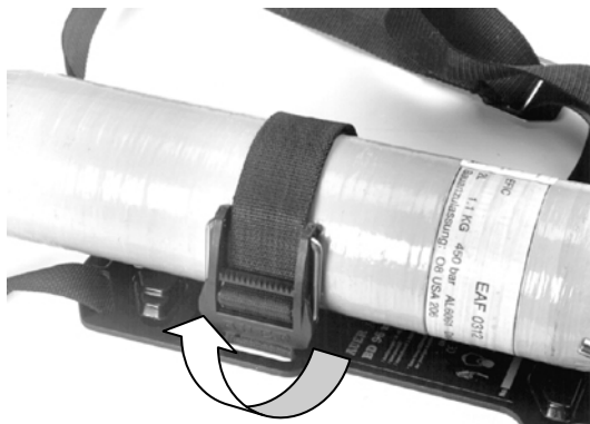
Fig. 7 Rimozione delle bombole di aria compressa
